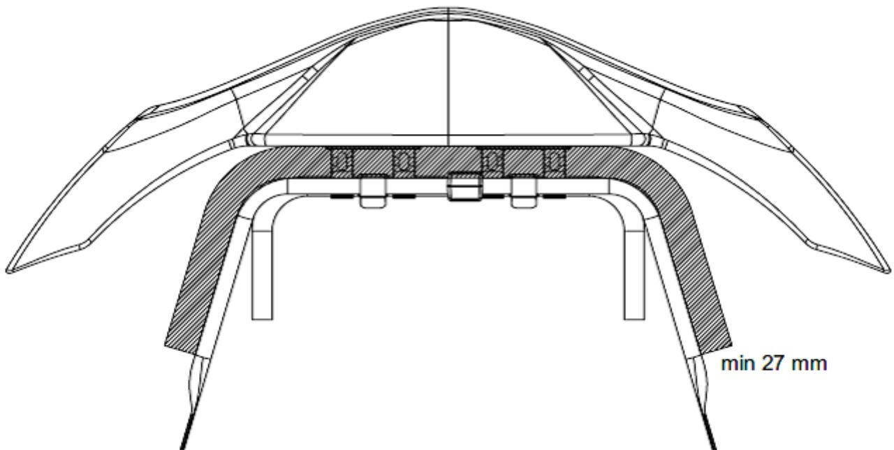
Pilote à bord, le carénage avant doit avoir une garde au sol de 25 mm minimum et de 60 mm maximum.
